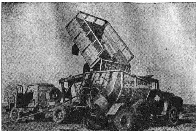
Рис. 22. Перегрузка игданита в бункер зарядной машины УЗА-3-II доставщиком САЗ-3502
